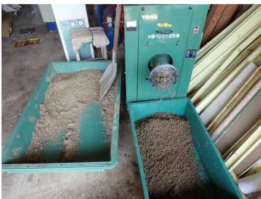
アマモペレット製造状況
